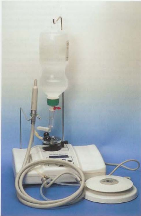
Abb. 1 Piezoelektronische Schaltbox mit Kühlvorrichtung und Handstück.
